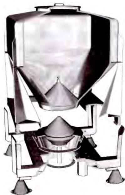
図2 マトコン IBC コンテナの断面概念図
