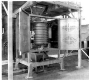
写真2 重力落下式ステンレス製シフター例
